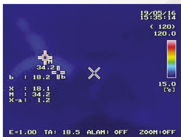
Рисунок 7 – Температуры следа резания при давлении на оросителе 2,0 МПа
