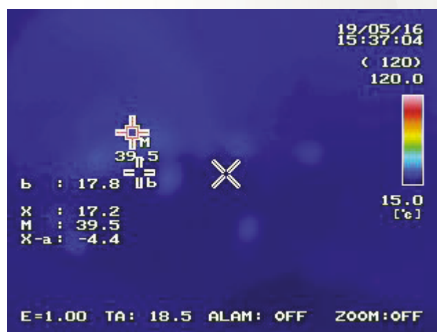
Рисунок 6 – Температуры следа резания при давлении на оросителе 1,6 МПа
