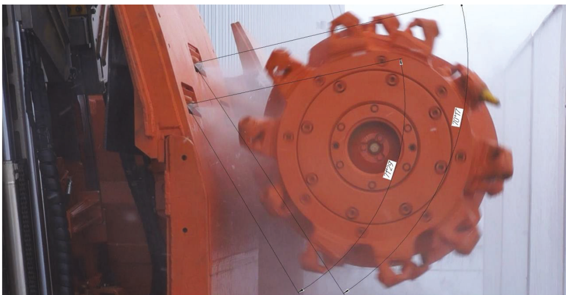
Рисунок 1 – Угол раствора факела оросителя при давлении на оросителе 1,0 МПа
