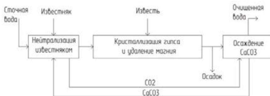
Рис. 4. Схема реагентной очистки известняком известью
