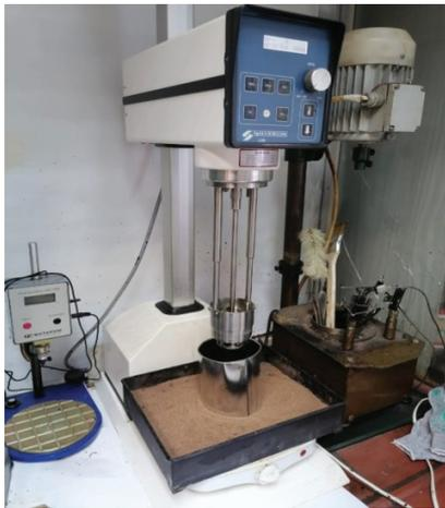
Рис. 2. Лабораторная установка испытания битума и его композиций с «КМА»
