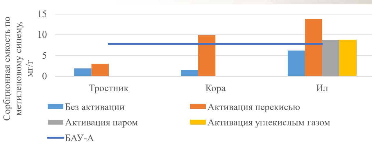
Рис. 4. Сорбционная емкость активированных различными методами сорбентов по метиленовому синему
