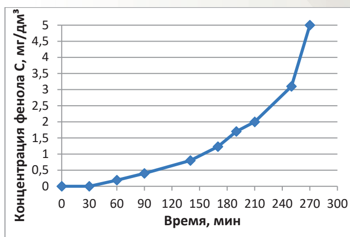
Рис. 7. Выходная кривая адсорбции фенола ГрМКШ в динамических условиях
