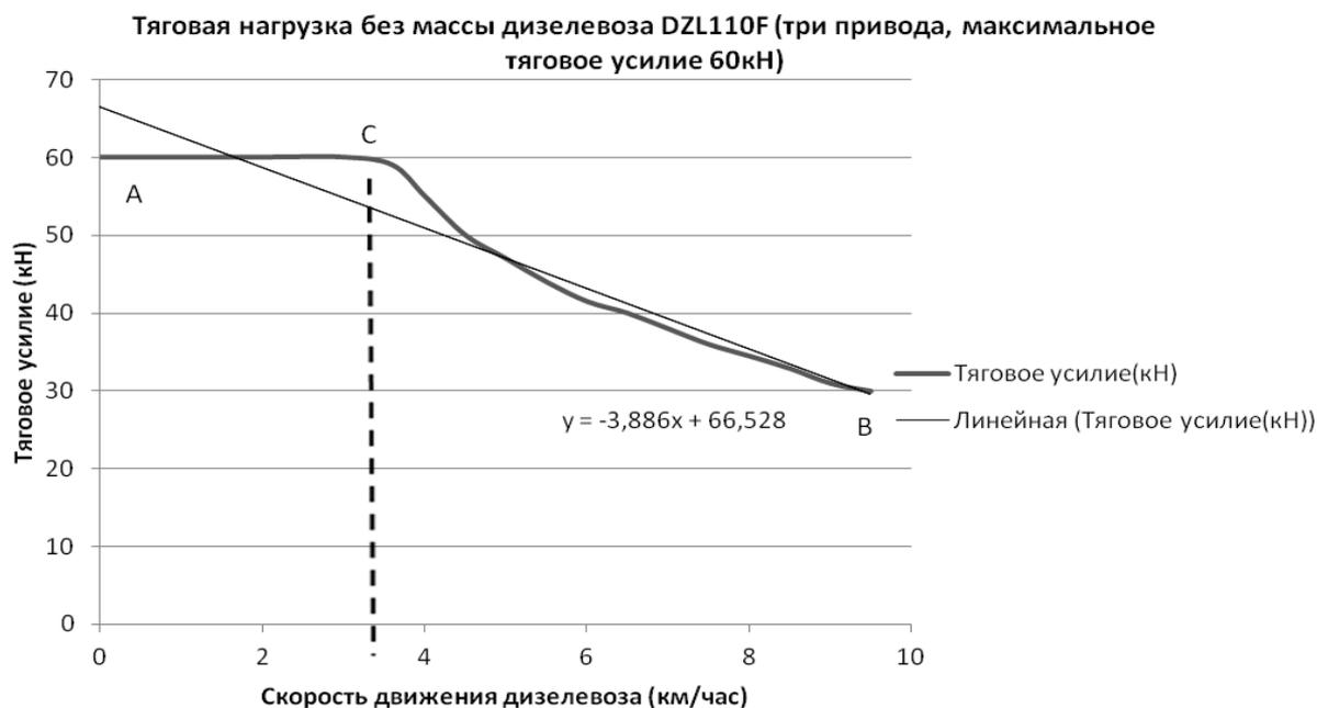
Рис. 4. График скорости движения дизелевоза DZL 110F при тяговом усилии 60 кН
