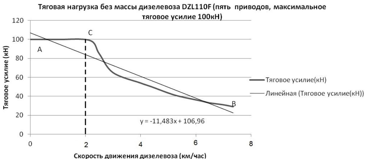
Рис. 6. График скорости движения дизелевоза DZL 110F при тяговом усилии 100 кН
