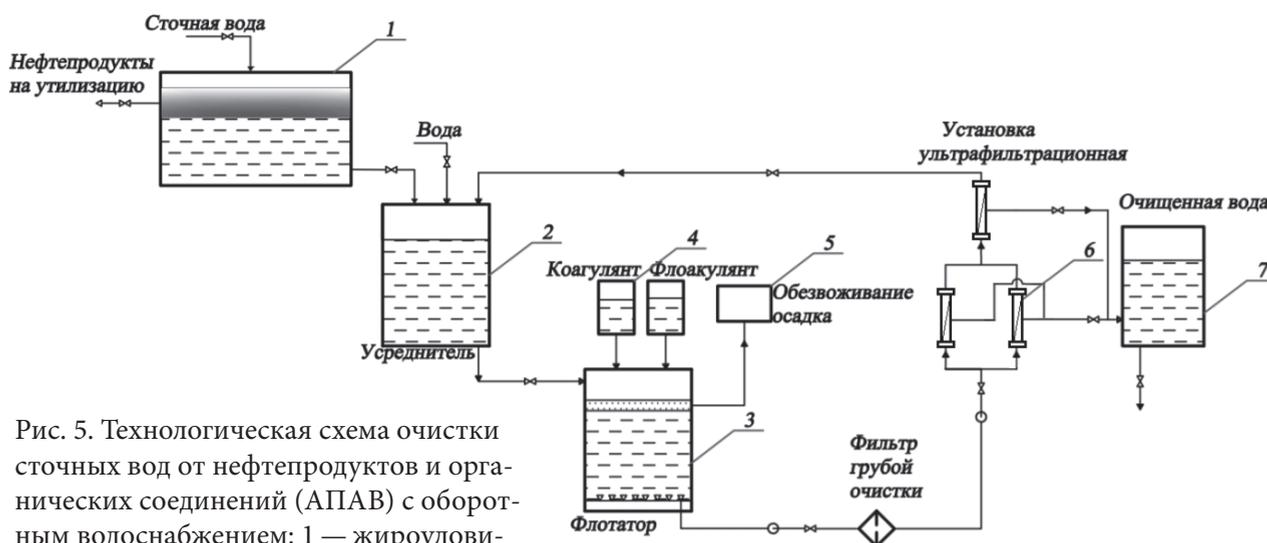
Рис. 5. Технологическая схема очистки сточных вод от нефтепродуктов и органических соединений (АПАВ) с оборотным водоснабжением: 1 — жиролоуловитель; 2 — усреднитель; 3 — флотатор; 4 — емкости с кислотой и щелочью; 5 — установка обезвоживания осадка; 6 — каскад ультрафильтрационных модулей; 7 — бак с очищенной водой
