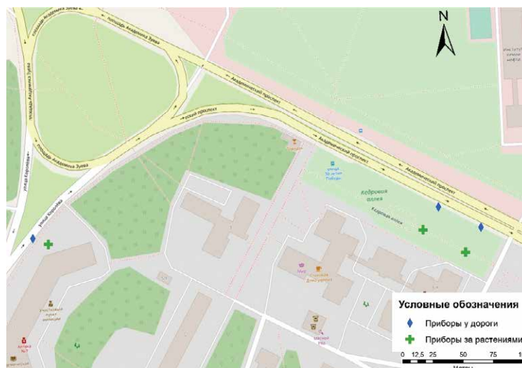
Рис. 1. Расположение приборов на участках измерений: а) в городе; б) и в) в Академгородке
