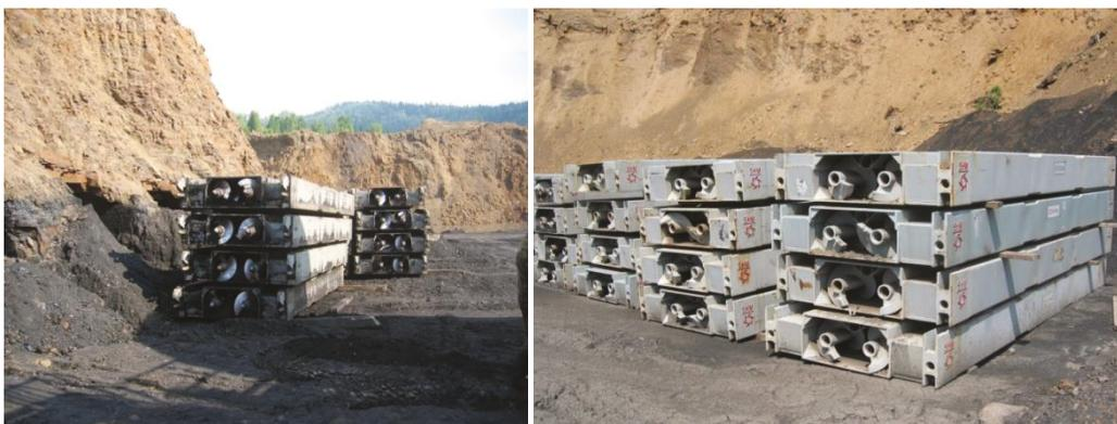
Рисунок 5 – Шнеково-транспортные секции
