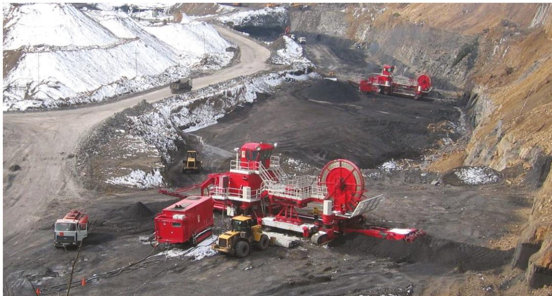
Рисунок 2 – Комплексы КГРП на разрезе «Распадский» производства Superior Highwall Miners (SHM)
