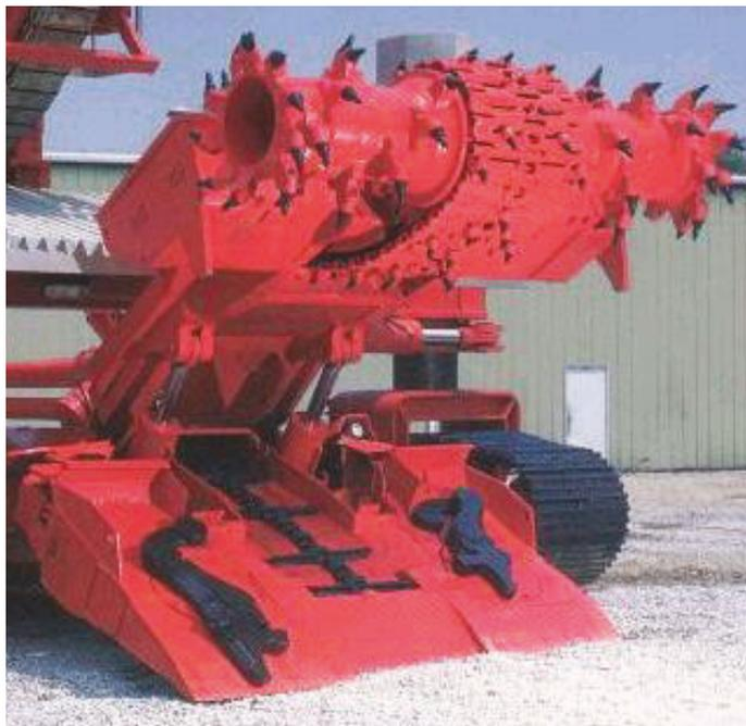
Рисунок 4 – Режущий барабан КГРП
