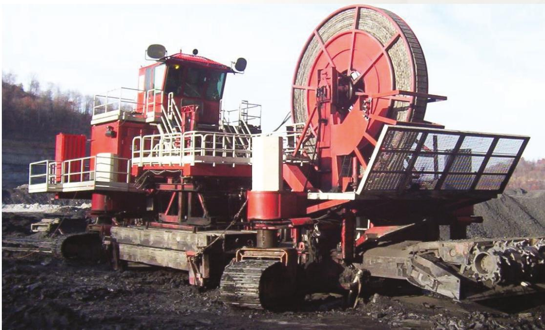
Рисунок 1 – Общий вид КГРП со стороны механического погрузчика секций (МПС)
