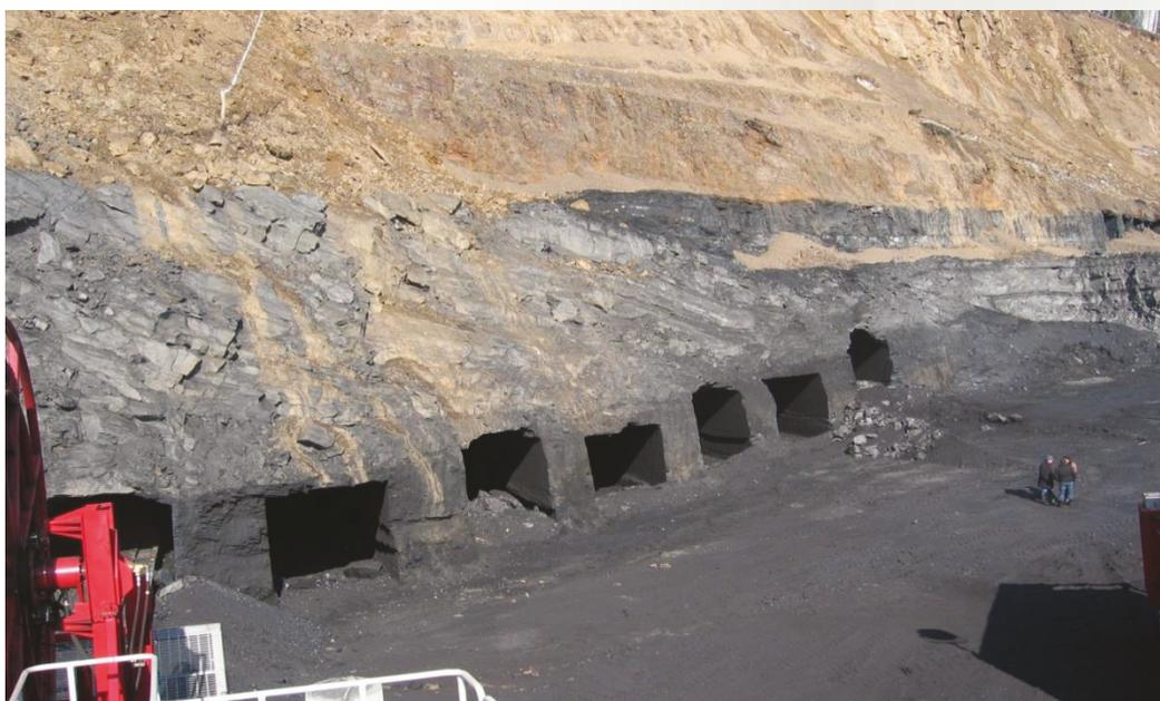
Рисунок 3 – Безлюдная выемка пласта с использованием КГРП, межкамерные целики
