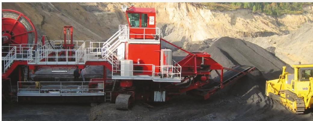
Рисунок 6 – Уголь разгружается в конус (штабель) прямо на грунт
