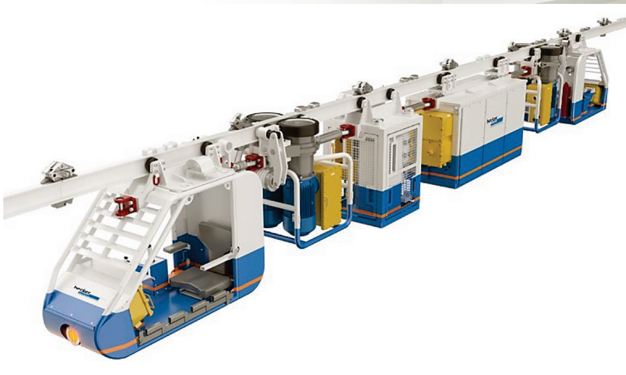
Рис. 1. Подвесной аккумуляторный локомотив (тягач) СА-190 фирмы Becker-Warkop
