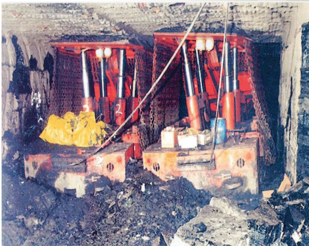
Рис. 3. Размещение передвижных крепей в горной выработке
