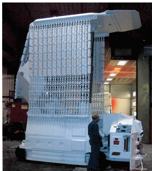
Рис. 2. Общий вид современной конструкции мобильного держателя кровли (MRS) с раздвижностью до 1600 мм (а) и до 5000 мм (б)
