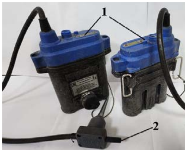
Рис. 1. Регистрирующее оборудование, применяемое для сейсмического просвечивания кровли: 1 — одноканальные автономные сейсмические регистраторы «Р-1»; 2 — геофон GS-20DX
