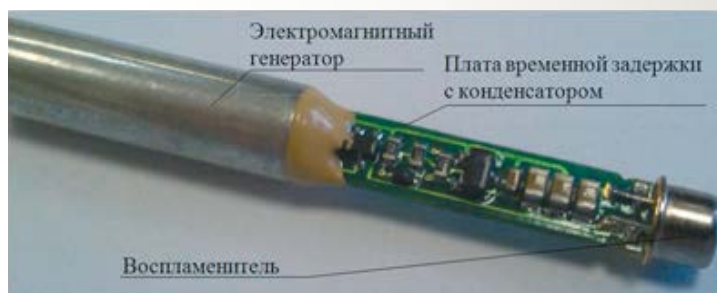
Рис. 1. Устройство «Искра-Т» с электронным замедлением инициирования
