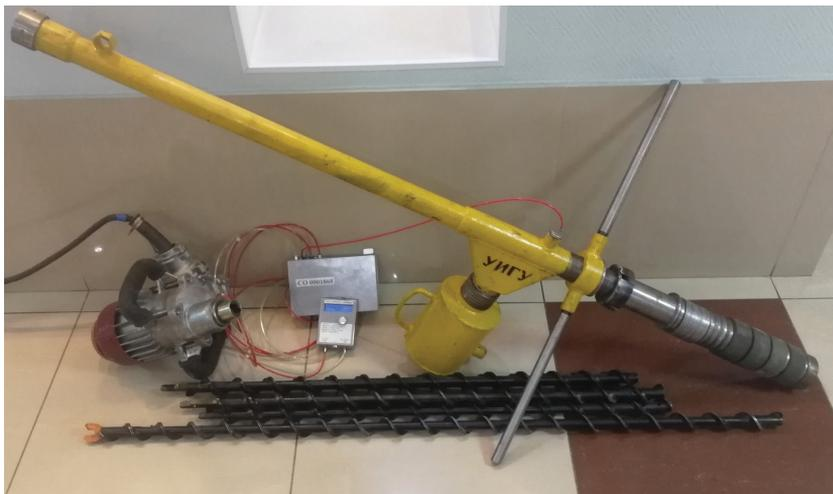
Рис. 3. Устройство для оперативного измерения газоносности угольного пласта и мониторинга его газодинамических показателей
