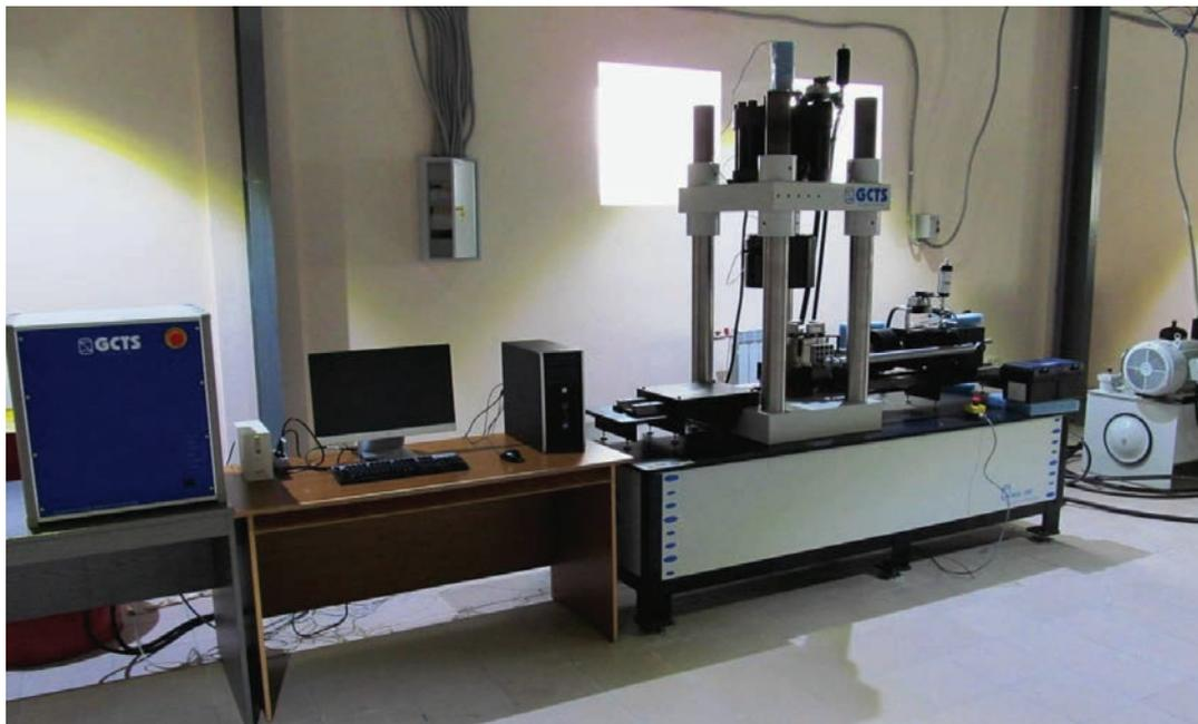
Рисунок 1 – Сервогидравлическая система RDS-500
