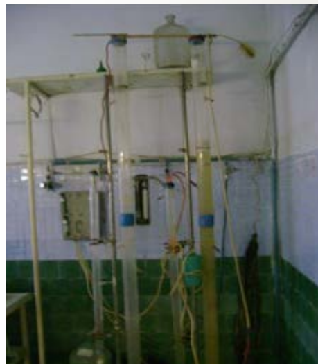
Рис.5. Лабораторная установка очистки сточных вод (опытный аэротенк и вторичный отстойник)
