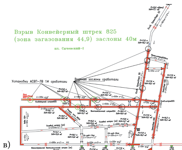
Рис. 7. Расчетные зоны высокого давления при взрыве в Конвейерном штреке 825 загазованной области длиной 44,9 м. а) — водяных заслонов нет, б) — водяные заслоны по 30 м, в) — по 40 м
