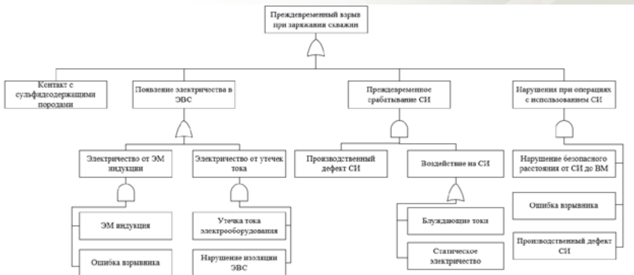
Рис. 3. Дерево отказов, приводящих к преждевременному взрыву при зарядании скважин
