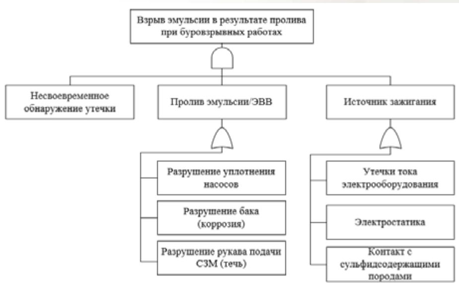
Рис. 2. Дерево отказов, приводящих к взрыву эмульсии в результате ее пролива при буровзрывных работах
