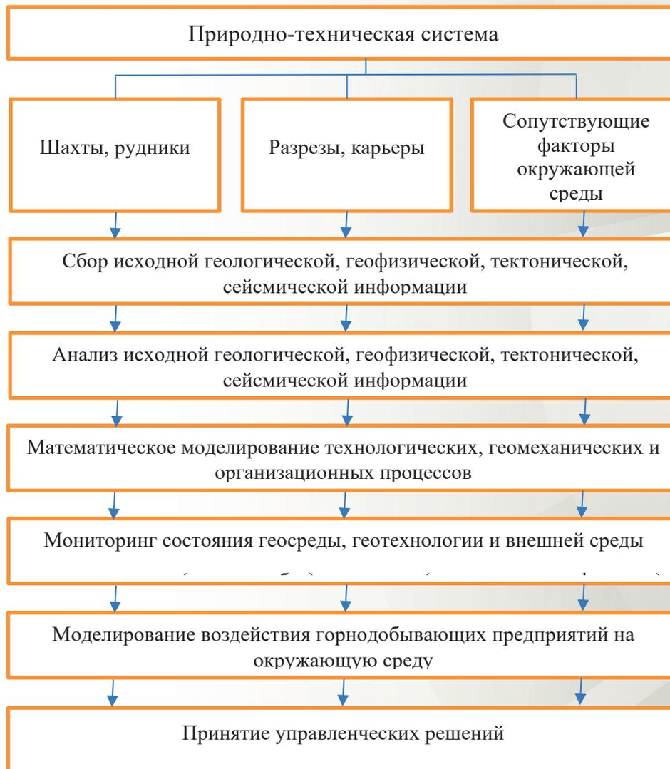
Рис.2. Блок-схема исследования взаимного влияния горных работ при подземной и открытой добыче угля
