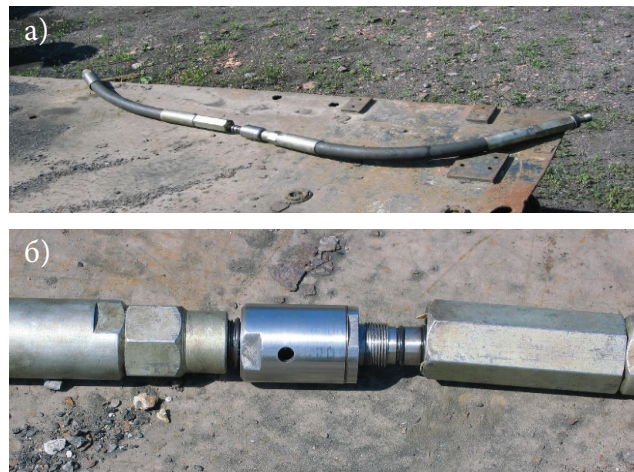
Рис. 3. Внешний вид двухстороннего надувного герметизирующего устройства (а) и межпакерный клапан (б): 1 — устьевой «Таурс»; 2 — клапан — синхронизатор; 3 — забойный «Таурс»; 4 — отверстие выхода рабочей жидкости в загерметизированную область скважины.
